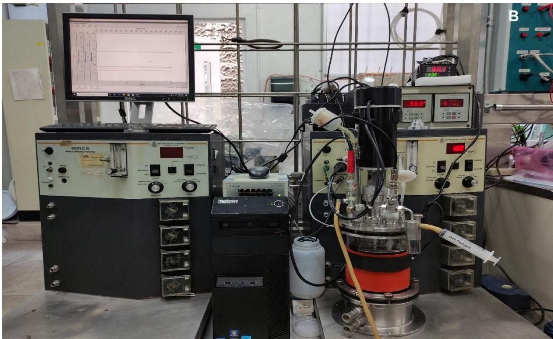
Figura 5.2: A) Esquema de la placa del Biorreactor. Se muestra el diseño y la instrumentación del equipo para la medición de los parámetros que caracterizan la cinética en estudio. B) Imagen del sistema ( New Brunswick_BioFlo III ) acoplado y automatizado.
