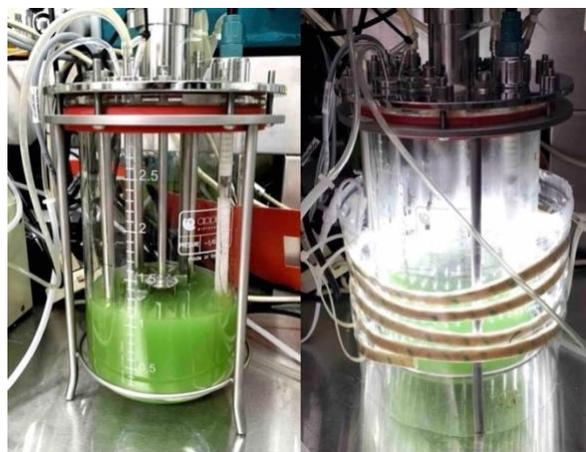
**Figura 3.1.** Fotobiorreactor de tanque agitado (FBTA) con luces LED utilizado para evaluar el co-cultivo CMA-SO durante los ensayos en lote.
