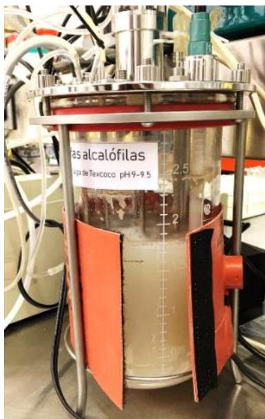
**Figura 2.1.** Reactor de tanque agitado para el enriquecimiento del CMA.
