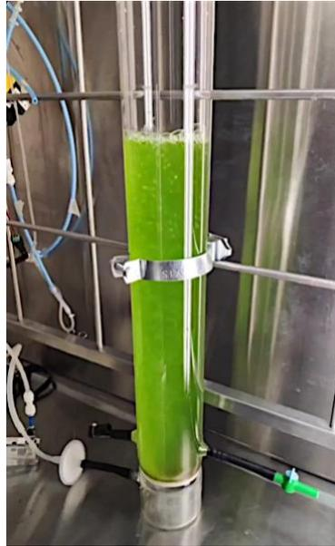
**Figura 2.2.** Columna de burbujeo utilizada para la propagación de *S. obtusiusculus*.
