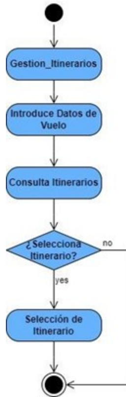
Figura 2.15. Diagrama de actividades de la funcionalidad “consulta de itinerarios” del sistema de reservaciones y ventas de una aerolínea. Nótese que este diagrama constituye un refinamiento del estado de actividad homónimo representado en la figura 2.14
