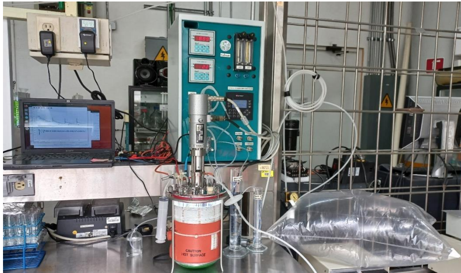
Figura 3.5 Sistema utilizado para el co-cultivo consorcio metanotrófico-cianobacteria.
