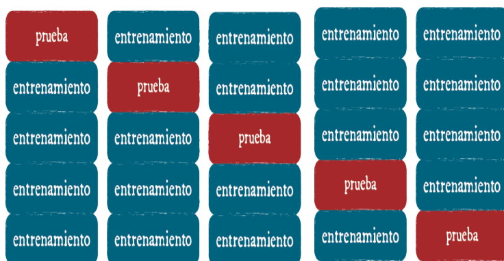
Figura 3.7: Método de k rondas entrecruzadas de validación partir del banco de datos E , en esta caso: k = 5 .
