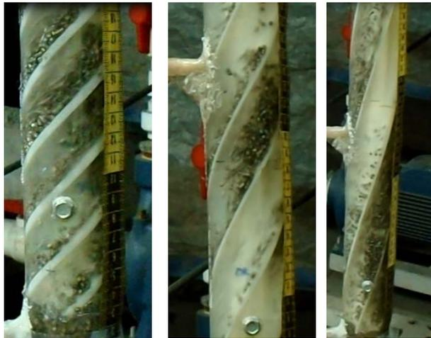
Figura 4.4. Baffle sólido con 4 arranques (de izquierda a derecha) a 45°, 60° y 75°
