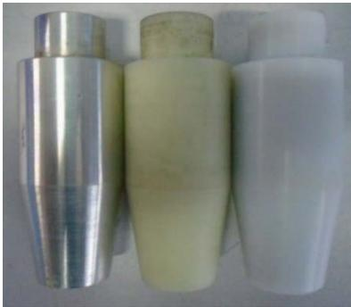
Figura 3.9. Tipos de flotadores empleados de izquierda a derecha Aluminio, Nylon y el original por parte del fabricante del rotámetro
