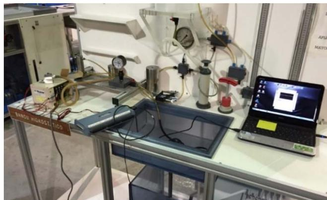
Figura 3.6. Calibración del transductor de presión diferencial
