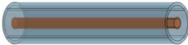
Figura 3.2 Intercambiador de tubos concéntricos
