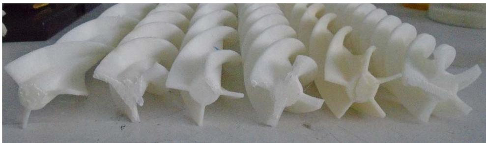
Figura 3.15. Baffles sólidos helicoidales con 3,4 y 5 hélices con  $45^\circ$ ,  $60^\circ$  y  $75^\circ$  de inclinación (vista longitudinal y transversal, respectivamente)
