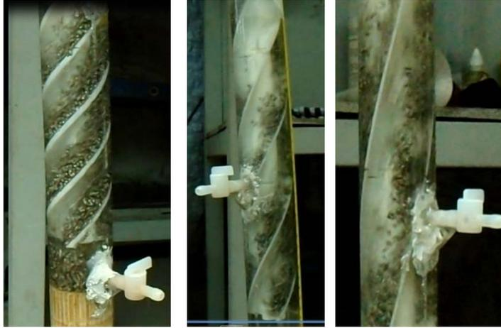
Figura 4.3 Baffle sólido con 3 arranques (de izquierda a derecha) a 45°, 60° y 75°
