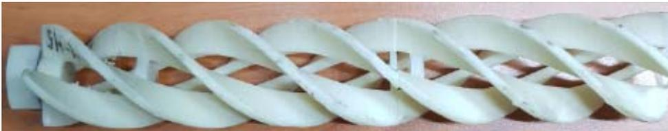
Figura 3.17 Baffle hueco con 4 hélices a 45°
