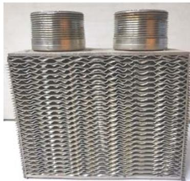
Figura 2.2 Corte transversal intercambiador de placas
