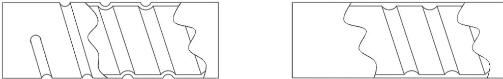
Figura 2.4. Tubo corrugado de dos y una fase
