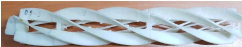
Figura 3.18 Baffle hueco con 5 hélices a 60°
