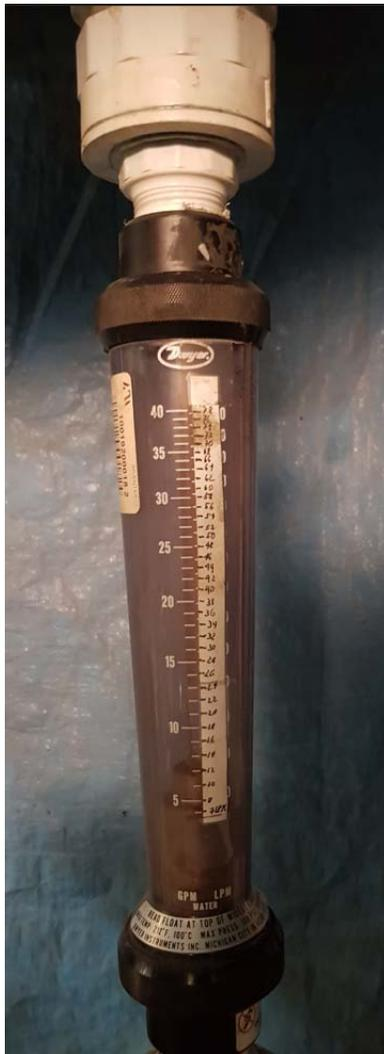
Figura 3.10. Rotámetro con nueva escala de calibración
