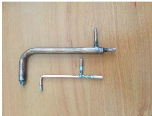
Figura 4.2 Tubos de *Pitot* fabricados para las pruebas
