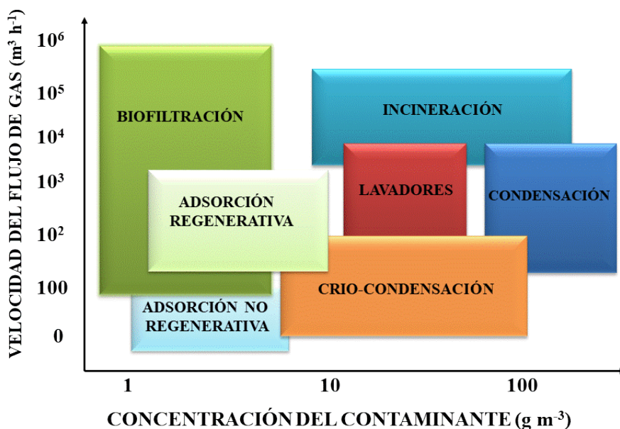
Figura 1.1 Clasificación de los diversos sistemas de tratamiento y su intervalo de operación (Cárdenas y col. 2003).
