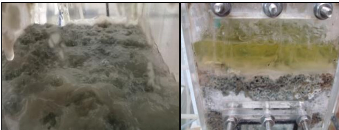
Figura 2.7. Imágenes de la formación de una capa de biomasa y acumulación de líquido en el lecho filtrante, día 317 de operación.
