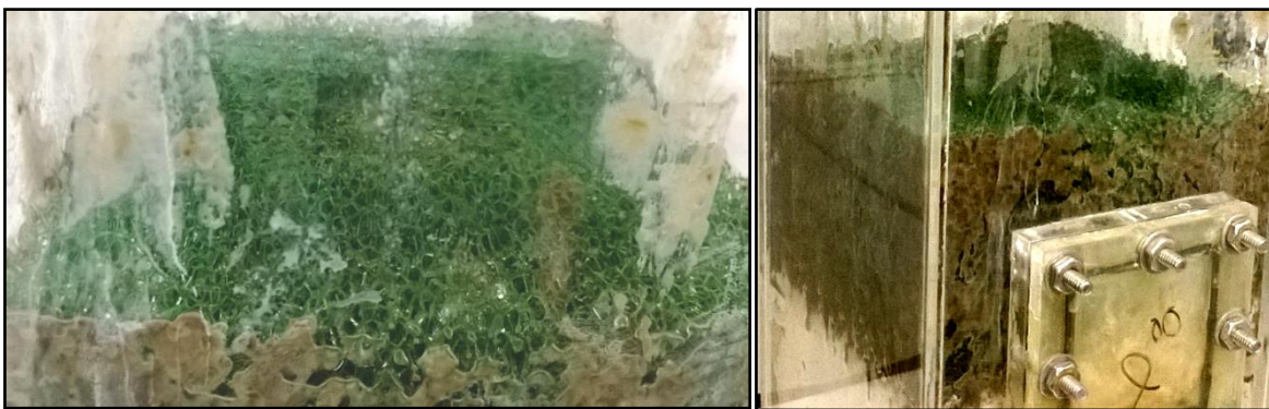
Figura 3.2. Imágenes del lecho filtrante (día 274 de operación), sección inferior del BLE.
