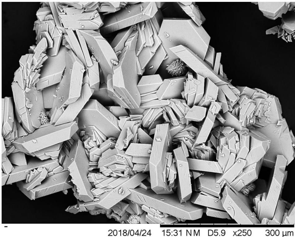
Figura 48. Micrografías de PBIA-Tm a 250 aumentos
