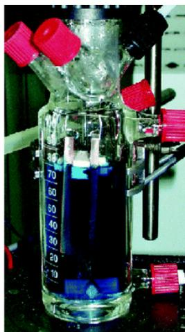
Figura 6. Celda electroquímica para la síntesis de MOFs, con electrodos de Cobre<sup>19</sup>
