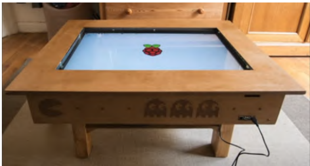
Imagen H4. DIY de una mesa táctil interactiva a partir de una pantalla plana (Lab1314, 2017).
