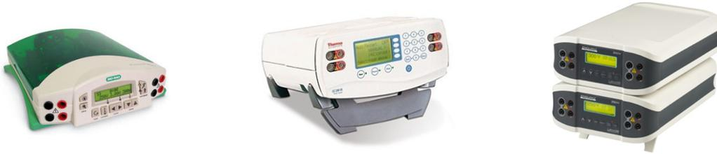
La fuente de poder es un aparato que tiene por función proveer de energía eléctrica a la cámara de electroforesis. El voltaje, el amperaje y el tiempo, pueden ser regulados de acuerdo a las necesidades del investigador. Esta fuente de poder provee voltaje, corriente o poder constante para la electroforesis (funcionando con el valor especificado para el parámetro constante).
