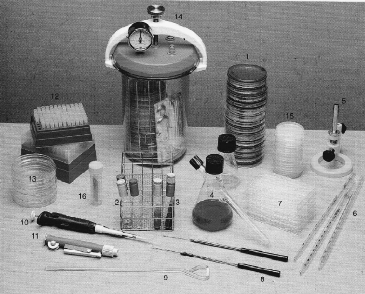
Figura 2.2. Material de laboratorio de Microbiología. 1) placas de Petri con medio de cultivo sólido; 2) tubos de ensayo con medio de cultivo líquido (caldo); 3) tubos de ensayo con medio de cultivo sólido; 4) matraz con brazo lateral para turbidimetría; 5) mechero Bunsen; 6) pipetas; 7) microplacas de 96 pocillos; 8) asas de siembra; 9) varilla de vidrio acodada; 10) micropipeta automática; 11) pipeteador manual; 12) puntas de pipeta automática; 13) placas de Petri; 14) Jarra para el crecimiento de microorganismos anaerobios; 15) placas de contacto RODAC; 16) lámina para análisis de superficies.
