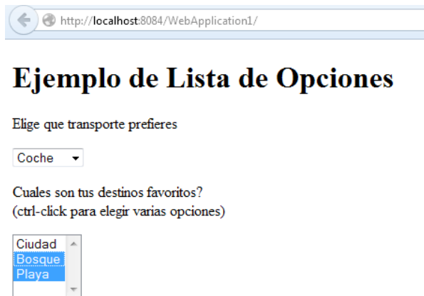
Figura II-11 Listas: en la primera se selecciona una opción, en la segunda, varias.
